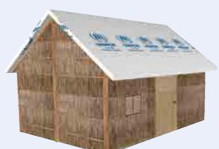
이 목재 쉘터는 난민 가족들을 비, 바람, 햇볕으로부터 더 강력히 보호하며, 내구성이 있는 재료로 보다 견고한 방식으로 만들어져서 더 오랜 기간 사용할 수 있습니다. 바닥과 지붕은 유엔난민기구 방수천을 덮어 사용할 수 있으며, 벽은 짚으로 채워져 있습니다. 생활 공간은 12m<sup>2</sup>(4×3m)이며 최소 높이는 1.7m입니다.
